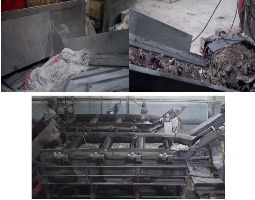
Şekil 2. Yıkama – kırma işlemi
