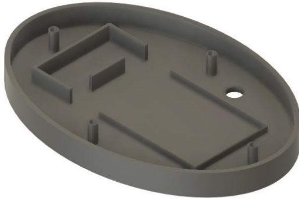
Şekil 5. Sistemi Kuracağımız Kutunun Üst Kısım 3D Çizimi
